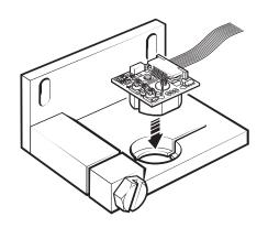
RGH34 の円筒形の本体を円形の溝(直径 12.10mm ±0.05mm)に配置し、クランプ機構(図の通り)を使用して固定するか、適切な接着剤で貼り付けることをお勧めします。光学部品が歪まないよう、円筒形の本体に均等に力がかかるようにしてください。
