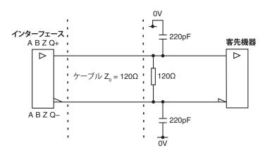
標準 RS422A ライン受信機回路 ノイズ耐性向上のためのコンデンサを推奨。
