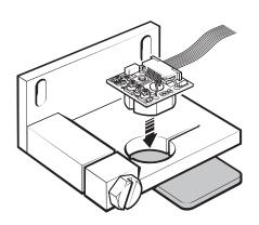
別の方法として、取り付け高さ公差を維持するために 1.5mm のシムを使用して、スルーホールブラケットにリードヘッドを固定します。この場合も、クランプ機構か適切な接着剤で本体を固定する必要があります。
