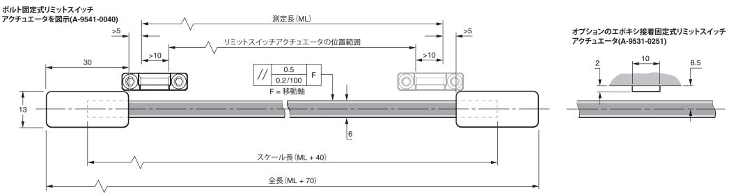
注:取り付け面の表面の粗さは 3.2Ra 以下とする必要があります。 移動軸に対するスケール表面の平行性 (リードヘッドの取り付け高さ公差) は、0.05mm 以内とする必要があります。
