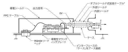
\*最高延長ケーブル長: RGI34B - 100m、RGI34T、D、G、X - 50m、RGI34N、W、Y、H - 20m
