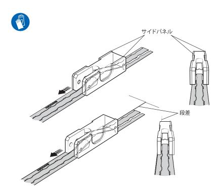
5. 下図のように、突起部の下に RTLA30 スケールを通して FASTRACK に挿入します。 RTLA30 スケールは、FASTRACK の中を押したり引っ張ったりして配置します。 または、下図のように RTL スケール挿入ツール (オプション) を使用すると便利です。
