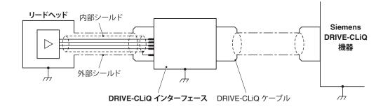
重要: ダブルシールドのリードヘッドケーブルを終端処理しなおす場合は、 内部シールドと外部シールドは絶縁するようにしてください。内部シールドと 外部シールドを接続すると、OV とアースがショートし、電気ノイズの問題が 発生する場合があります。
