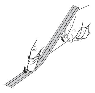
中央から両端に向かって不織布の上から指を押し付けて、FASTRACKを機材にしっかりと接着します。
