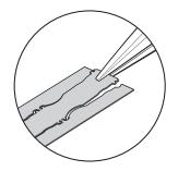
3. 剥離紙をはがし、FASTRACKを基準器、ストレートエッジまたはダウエルピンに合わせて機材に取り付けます。
