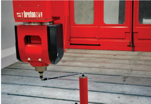
Breton SpA 社での、レニショー QC20-W ボールバーを用いた機械の位置決め性能チェックの様子
