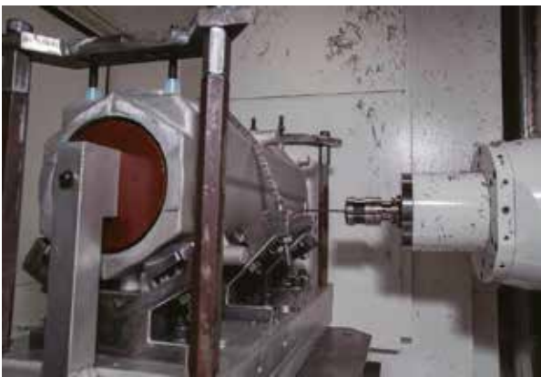
手动对准工件并在坐标测量机上进行检测的过程已被雷尼绍RMP60和RMP600测头测量系统所取代，从而节省宝贵的时间。
