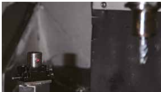
NC4非接触式对刀系统可节省QEP的对刀时间。
