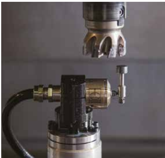
雷尼绍TS27R和NC4对刀仪每加工批次可以为QEP节省时间约85分钟。
